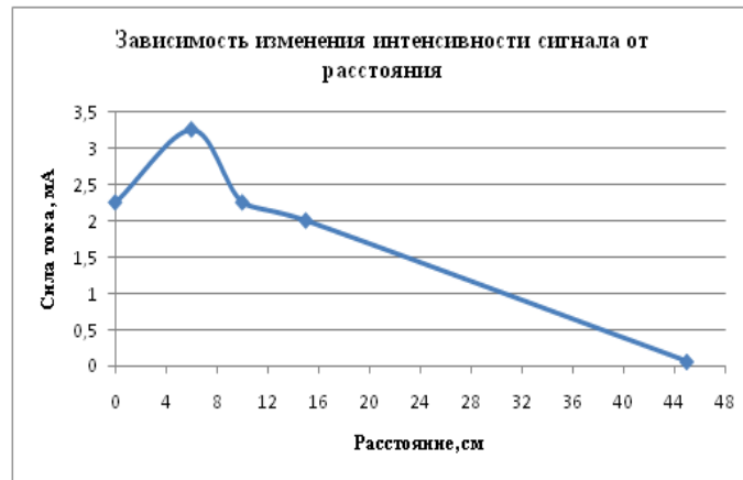
Рисунок 13. График зависимости изменения интенсивности сигнала от расстояния
