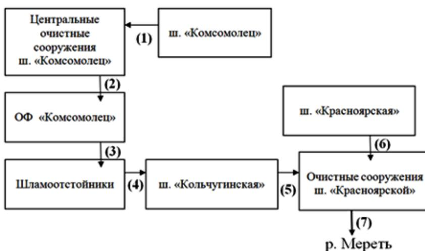
Рисунок 1 – Схема транзита промышленных стоков ш. «Комсомолец» в р. Мереть. На схеме обозначены процессы: (1) – сброс шахтных вод в центральные очистные сооружения; (2) – отбор вод для использования в технологических процессах обогащения; (3) – сброс для отстаивания в шламоотстойниках; (4) – сброс для очистки в отработанных выработках ш. «Кольчугинская»; (5), (6) – сброс в очистные сооружения ш. «Красноярской»; (7) – сброс очищенных стоков в р. Мереть.
