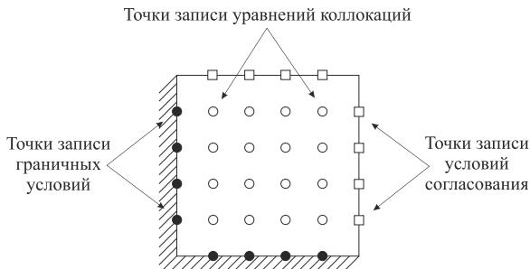
Рисунок 2 – Пример расположения точек записи уравнений в методе КНН.
