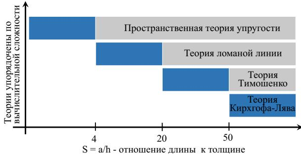
Рисунок 5 – Область применимости теорий в зависимости от относительной толщины пластин для рассмотренной постановки. Рекомендованная область выделена синим цветом.
