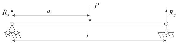
Рисунок 7 – Схема модели трехточечного изгиба балки прямоугольного сечения. Здесь  $l$  – длина балки;  $a$  – расстояние до точки приложения сосредоточенной нагрузки  $P$ ;  $R_A$ ,  $R_B$  – реакции опор.
