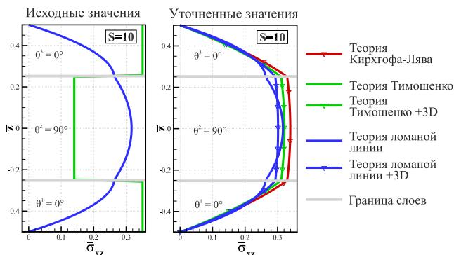
Рисунок 6 – Распределения компоненты тензора напряжений  $\sigma_{xz}(0, a/2, z̄)$  до и после уточнения (+3D) в трехслойной пластине по толщине.
