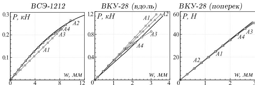
Рисунок 8 – Экспериментальные (сплошные кривые) и расчетные зависимости прогиба в центре балки от нагрузки для разных видов аппроксимаций физических соотношений.
