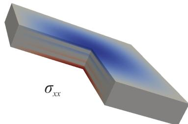
Рисунок 4 – Распределения компоненты тензора напряжений  $\sigma_{xx}$  в семислойной пластине ( $S = 10$ ).
