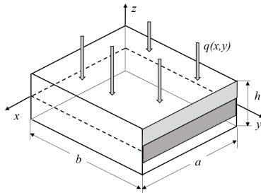
Рисунок 1 – Слоистая прямоугольная пластина под действием поперечной нагрузки.
