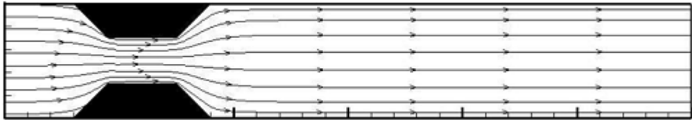
Рис. 2.11 Линии тока течения в плоском диффузоре при U(t)=1 , Re=1200 , h=0.02 , \tau=0.01 , t=0.02
