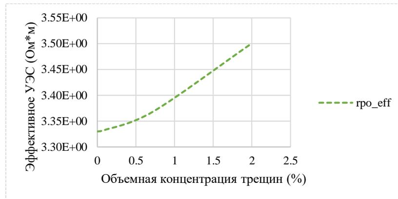
Рисунок 4.24 – Изменение эффективного УЭС при разрушении образца
