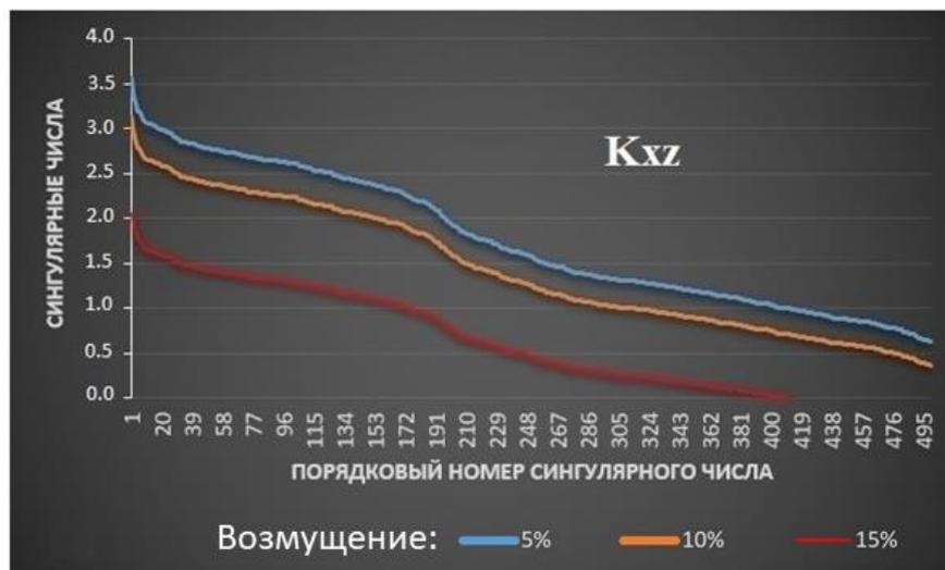
Рисунок 32 – Сингулярные числа матрицы Фреше при использовании классического МКЭ и при возмущении компоненты  $K_{xz}$
