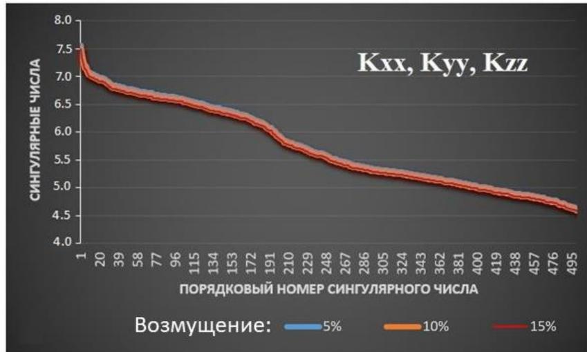
Рисунок 30 – Сингулярные числа матрицы Фреше при использовании классического МКЭ и при возмущении диагональных компонент тензора
