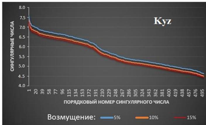
Рисунок 37 – Сингулярные числа матрицы Фреше при использовании разрывного метода Галёркина и при возмущении компоненты  $K_{yz}$
