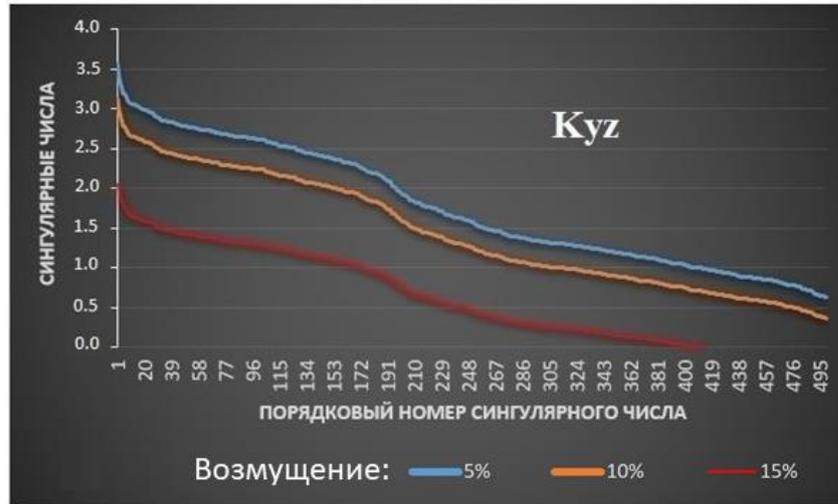
Рисунок 33 – Сингулярные числа матрицы Фреше при использовании классического МКЭ и при возмущении компоненты  $K_{yz}$
