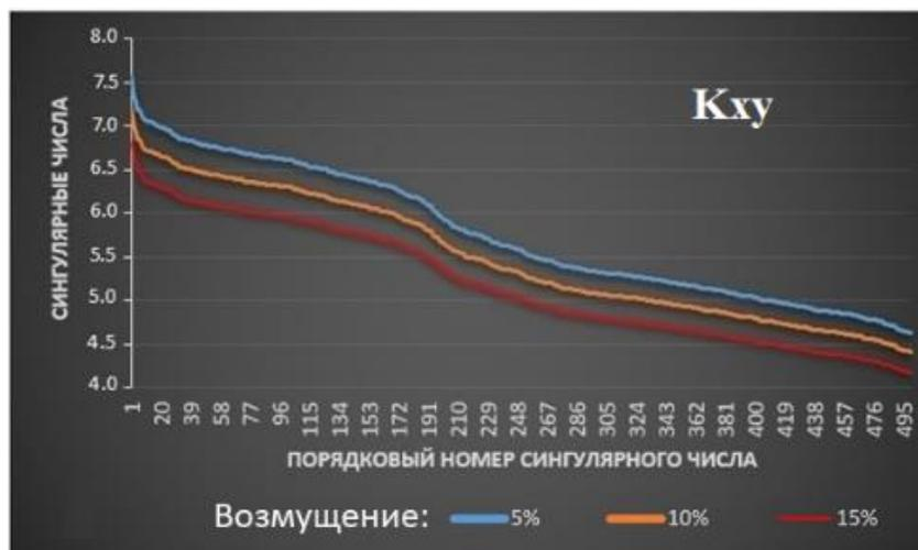
Рисунок 35 – Сингулярные числа матрицы Фреше при использовании разрывного метода Галёркина и при возмущении компоненты  $K_{xy}$
