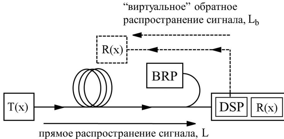
Рисунок 18 — Схематическое изображение линии связи с применением метода обратного распространения сигнала.
