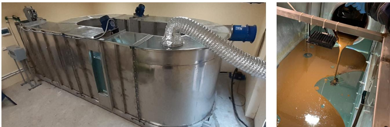
Рис. 2. Тестирование диспергентов на мезомасштабной установке, позволяющей моделировать естественное состояние поверхности моря
