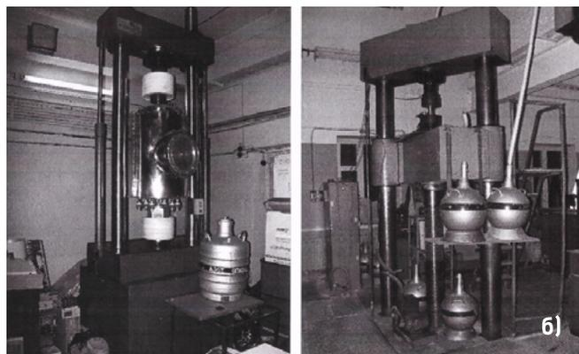
Рис. 3. Экспериментальные исследования при нормальных и низких температурах. Стендовые испытания рамы тележки тепловоза на усталость при действии эксплуатационных нагрузок (а); лабораторные испытания образцов при низких и криогенных температурах (б); измерения локальных деформаций.
