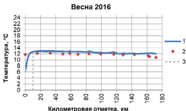
Рис. 3. Расчетные значения температуры потока, построенные для прогнозных режимов и фактические значения температуры потока, измеренные датчиком ОПТ за весенний период 2016г.
