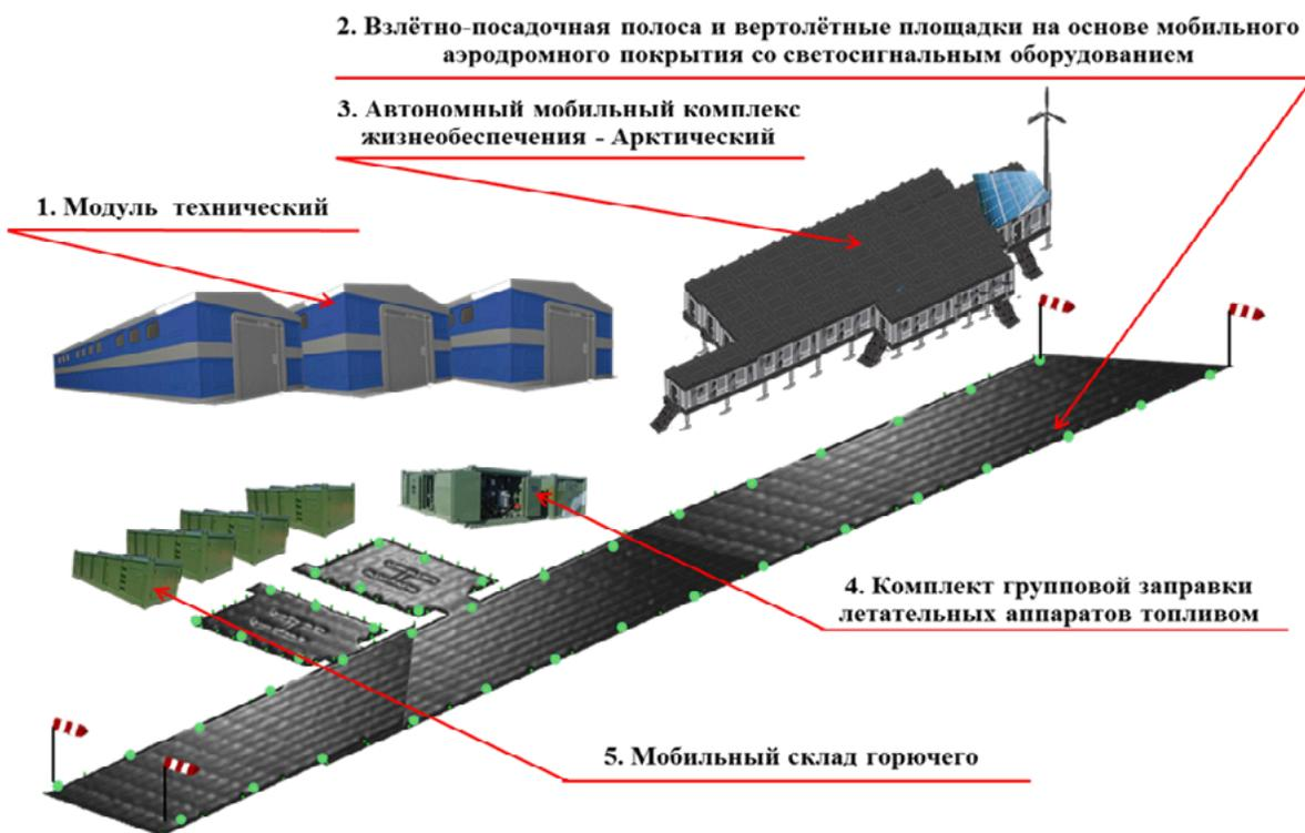
Рис. 1. Модель мобильного комплекса жизнеобеспечения воинских подразделений видов Вооруженных Сил Российской Федерации и родов войск в Арктическом регионе
