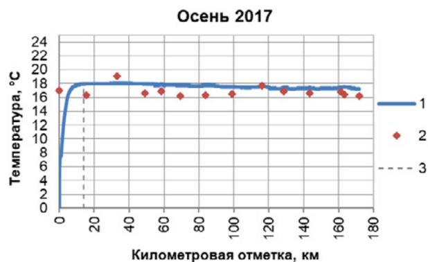
Рис. 4. Расчетные значения температуры потока, построенные для прогнозных режимов и фактические значения температуры потока, измеренные датчиком ОПТ за осенний период 2017г.
