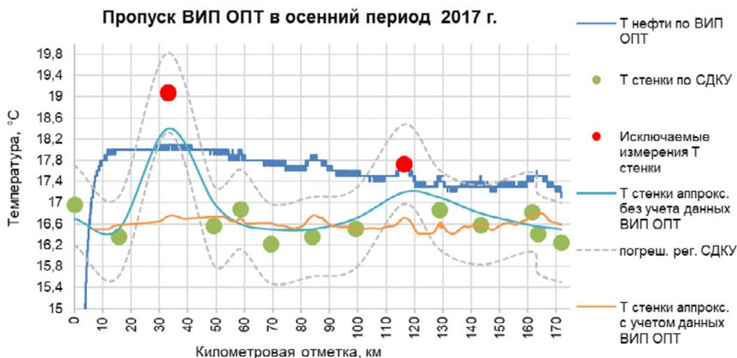
Рис. 8. Выбор формы аппроксимирующей функции температуры стенки по длине МН.
